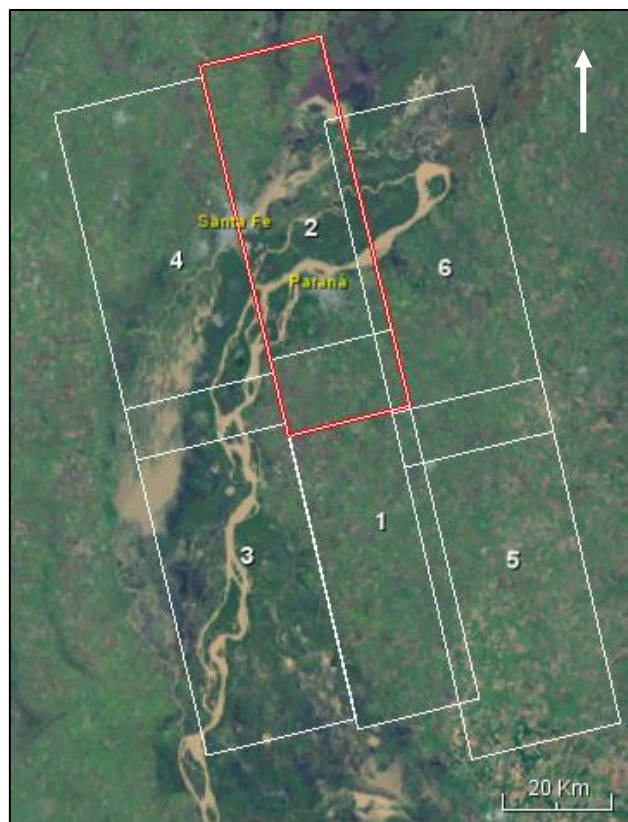
Figura 37. Imágenes ALOS PALSAR-1 PLR (cuádruple polarización) formato nivel 1.1 aptas para realizar análisis polarimétricos. Fuente: Alaska Satellite Facility .
