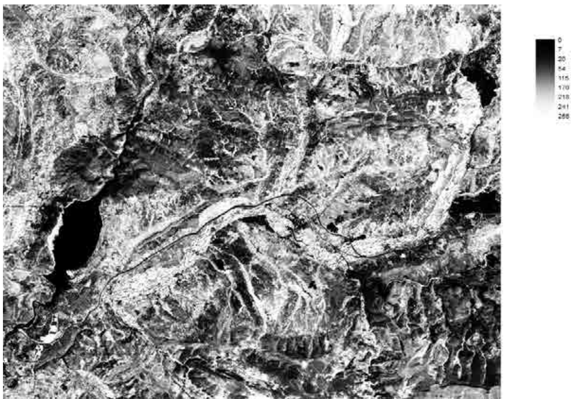
Figura 5: Banda 4 ETM+ realizada una expansión por ecuilización del histograma (rango 0-255)
