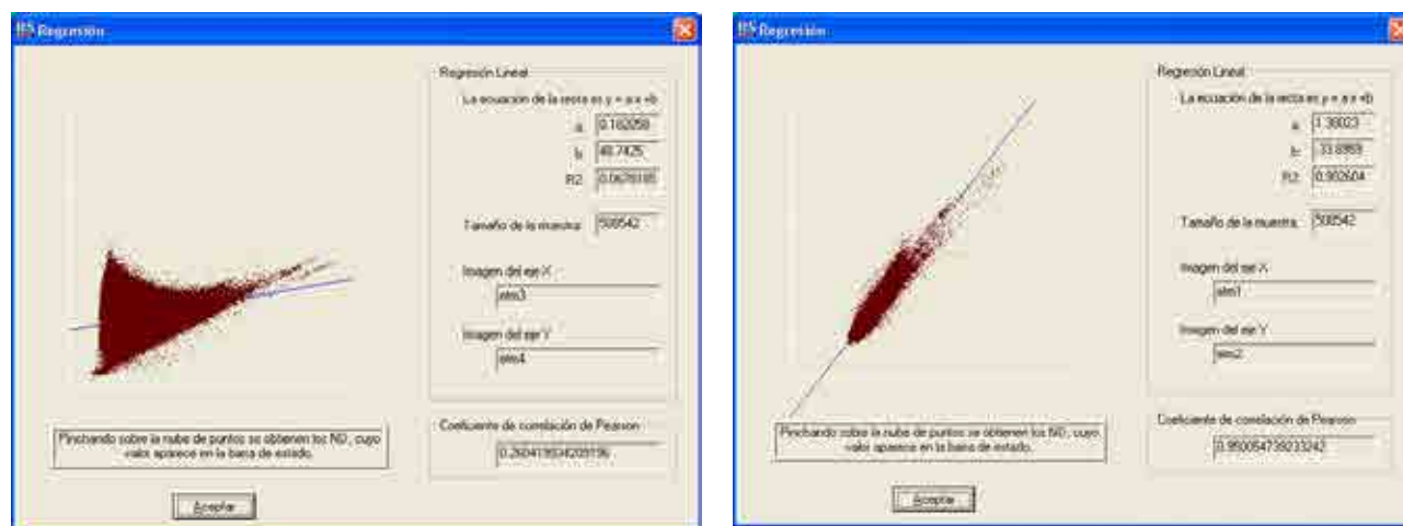
Figura 21: Estudio de la correlación entre bandas. A la izquierda banda 3 frente a banda 4, a la derecha banda 1 frente a la banda 2
