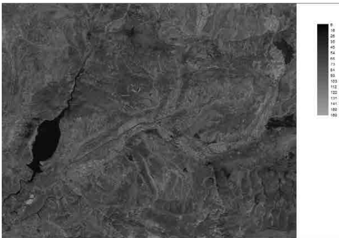
Figura 4: Banda 4 ETM+ realizado con una expansión lineal del contraste con rango interactivo (rango elegido: 0-180)
